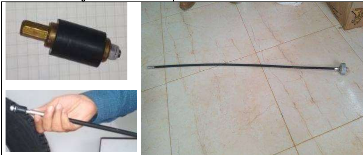
Imagen 43 Materiales de suspensión del servicio de acueducto
