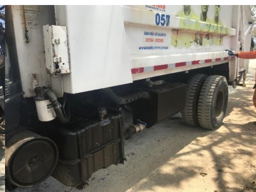
Ref. Caja de lixiviados
