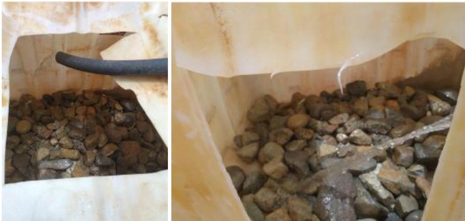
Imagen 36. Aireación del permeado antes de ser vertido al río Hondo.
