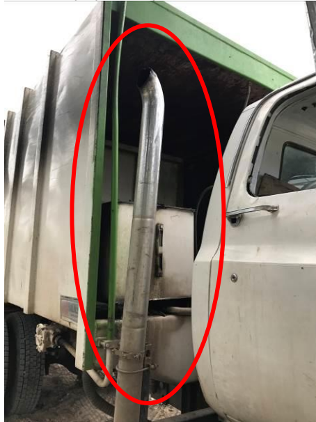
Ilustración 13. Tubo de escape por debajo de su altura máxima. Vehículo OXD 057.
