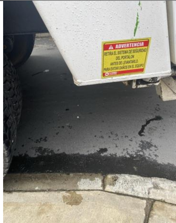
Pérdida de lixiviado
