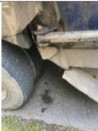
Pérdida de lixiviado
