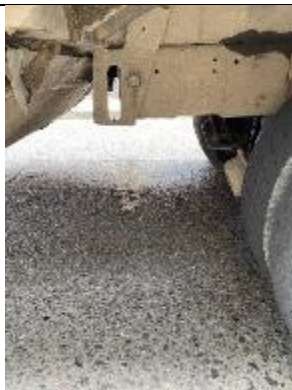
Pérdida de lixiviado
