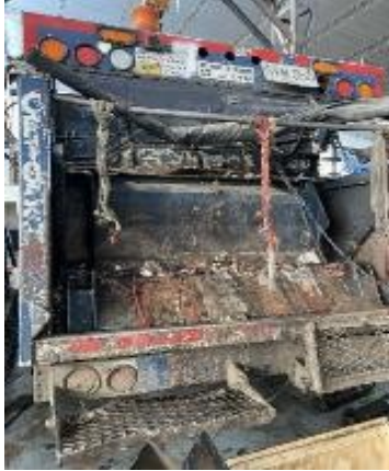
Caja compactadora con residuos en zona de mantenimiento
