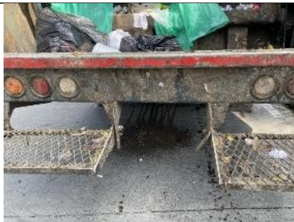
Pérdida de lixiviado
