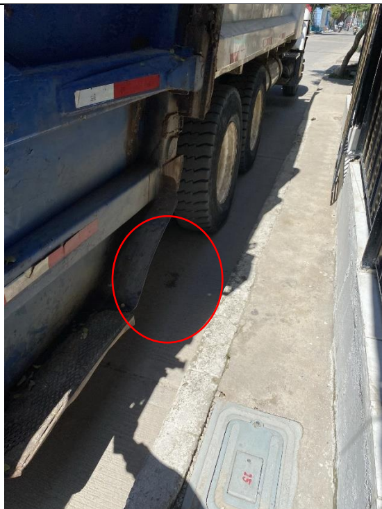
Pérdida de lixiviado del compactador WEO535
