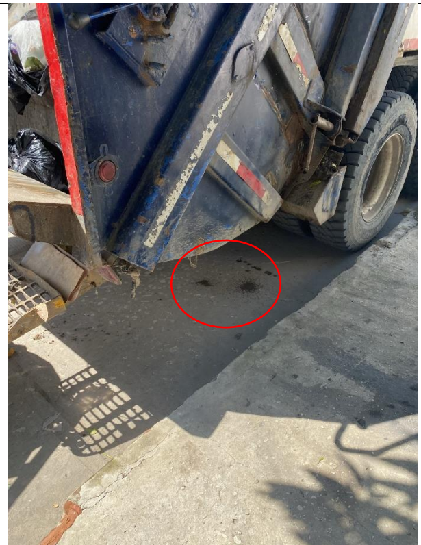
Pérdida de lixiviado del compactador WEO535
