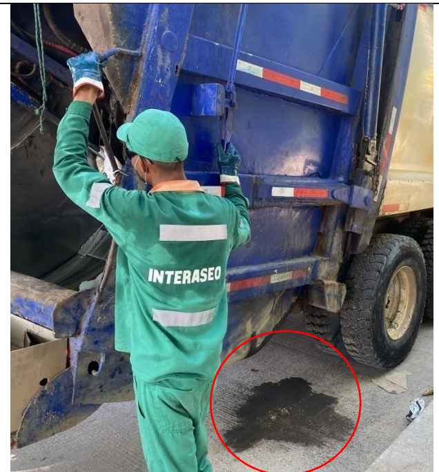
Pérdida de lixiviado en compactador UYQ226
