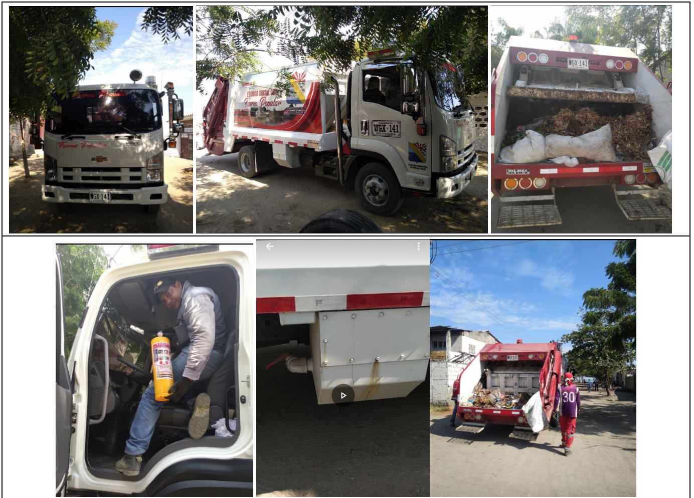
Imagen 3. Vehículo de recolección y transporte de residuos sólidos del municipio de Sitionuevo, donde se ilustran las cajas de lixiviados, ubicación de baliza, escape, controles equipo de compactación y extintor. Por último, documentos de circulación.
