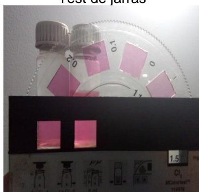
Medidor de cloro
