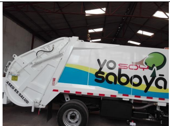
Foto 31. Compactador utilizado para la recolección y transporte de residuos sólidos
