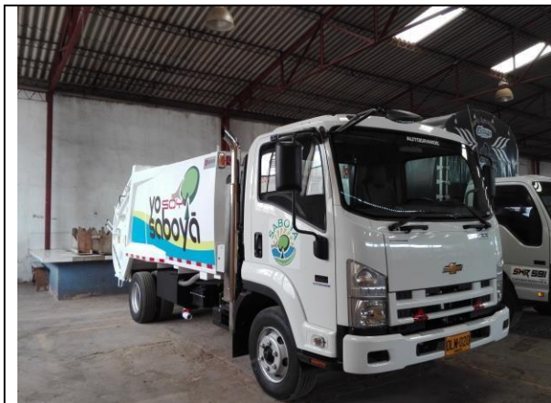
Foto 30. Compactador utilizado para la recolección y transporte de residuos sólidos
