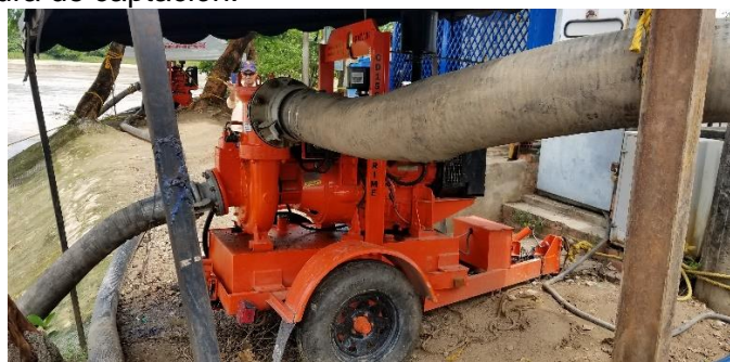
Planta de bombeo móvil.
