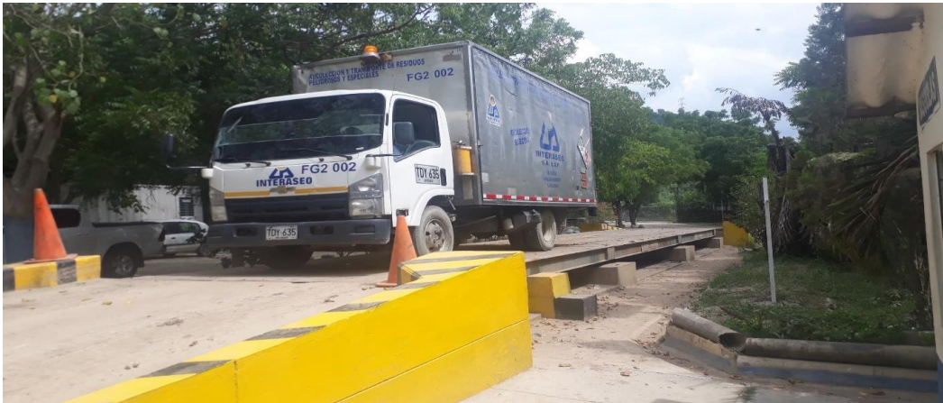
Imagen 52. Báscula de Pesaje Relleno Sanitario
