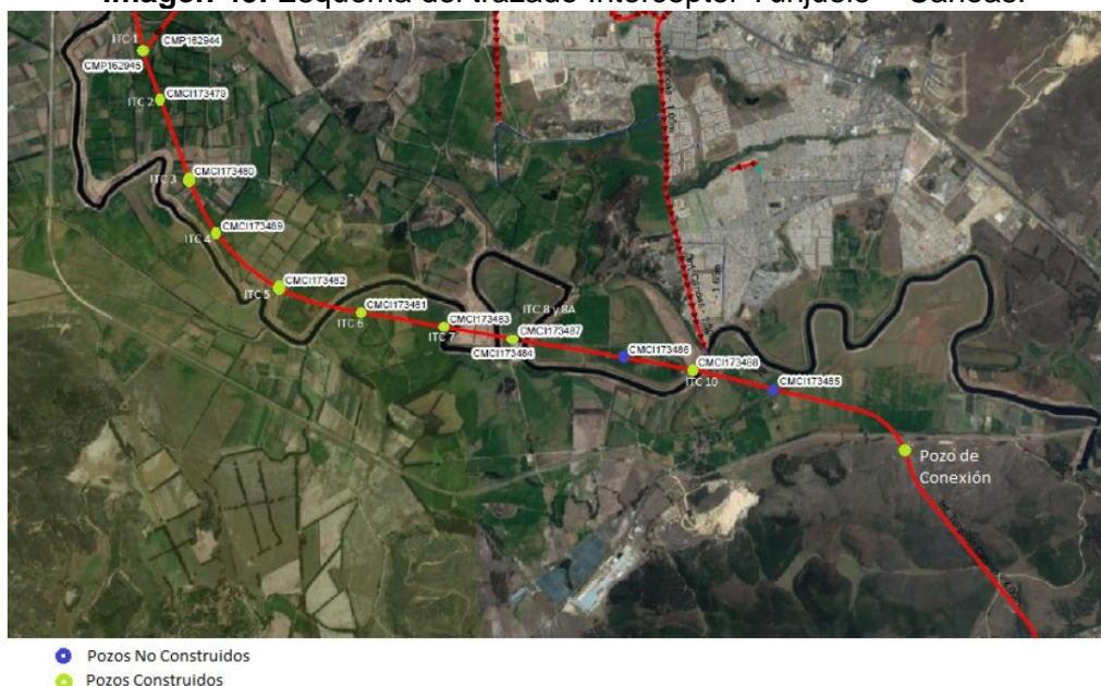
Imagen 49. Esquema del trazado Interceptor Tunjuelo – Canoas.
