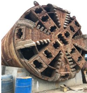
Pozo de Conexión – Extracción (antiguo pozo ITC 12). Máquinas tuneladoras en proceso de desmonte
