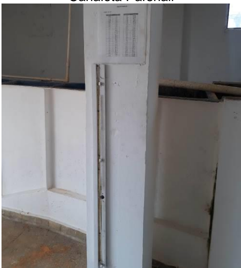
Medición caudal de ingreso
