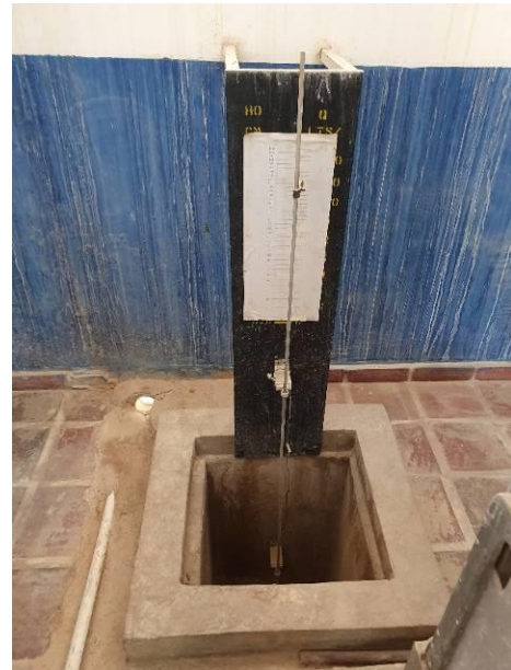
Boya para la medición del caudal de entrada
