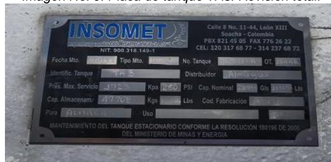
Imagen No. 9. Placa de tanque TA3. Revisión total.
