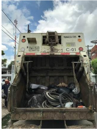
Imagen 18. Pérdida de líquido (lixiviado). Vehículo SWV 360.
