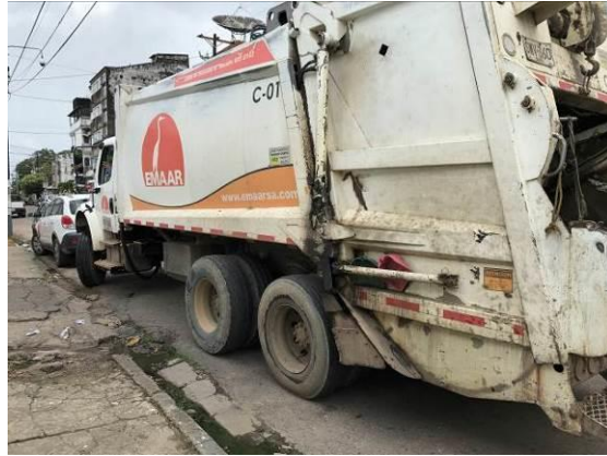
Imagen 18. Pérdida de líquido (lixiviado). Vehículo SWV 360.
