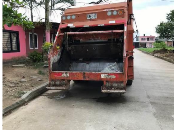
Imagen 20. Pérdida de líquido (lixiviado). Vehículo SWV 361.
