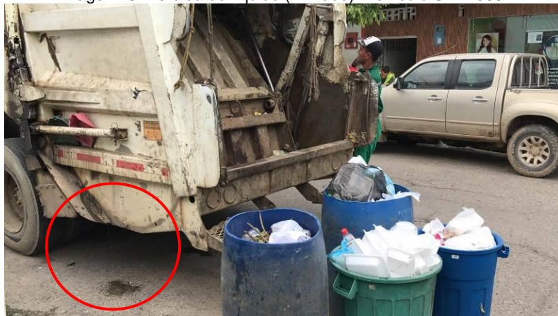
Imagen 18. Pérdida de líquido (lixiviado). Vehículo SWV 360.
