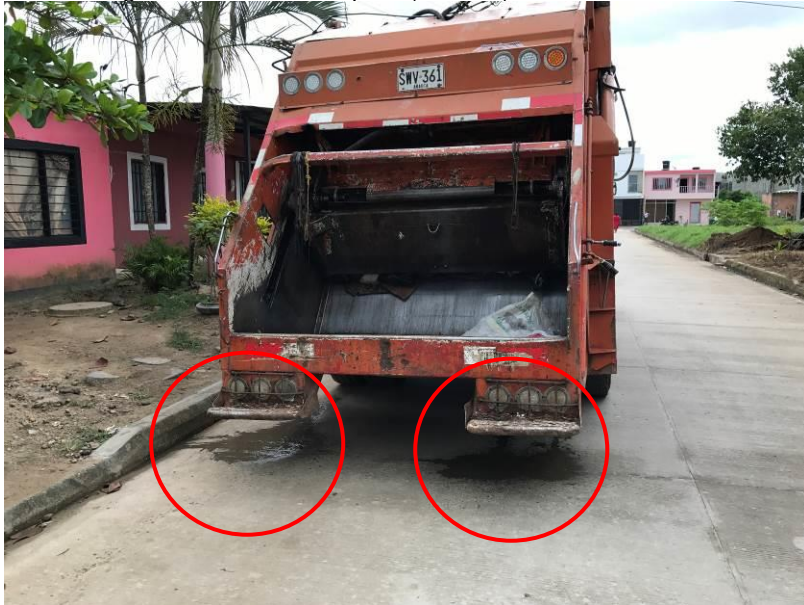
Imagen 20. Pérdida de líquido (lixiviado). Vehículo SWV 361.
