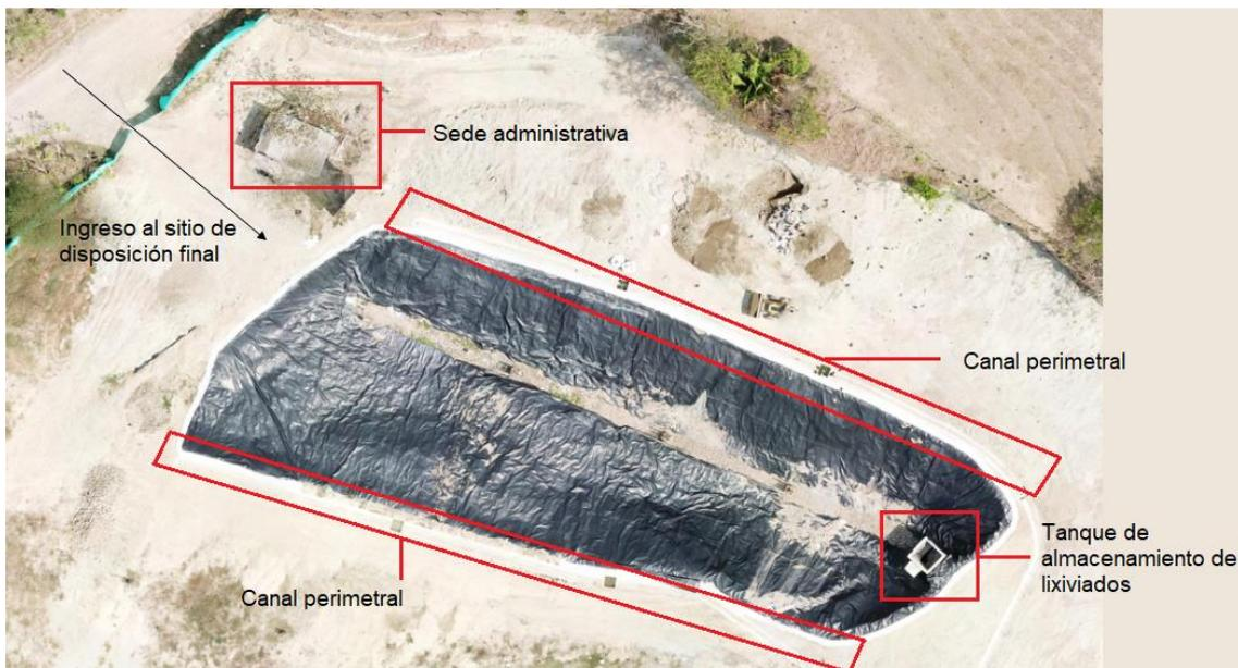
**. Celda provisional para la disposición de residuos sólidos en fase de adecuación, antes de la disposición de residuos**
