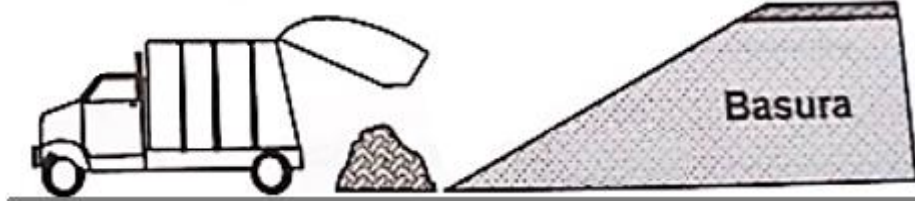
Imagen 24. Disposición de abajo hacia arriba – descarga en reversa
