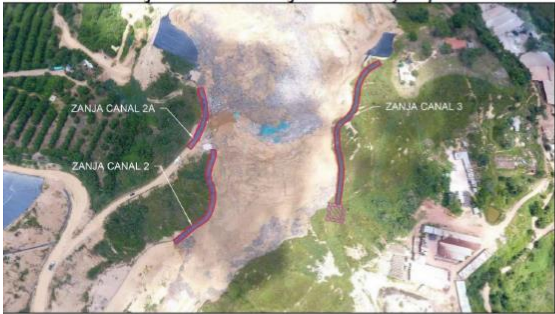
Imagen 41. Localización y dimensiones zanjas 2 y 3 Celda 4 Fase 2.
