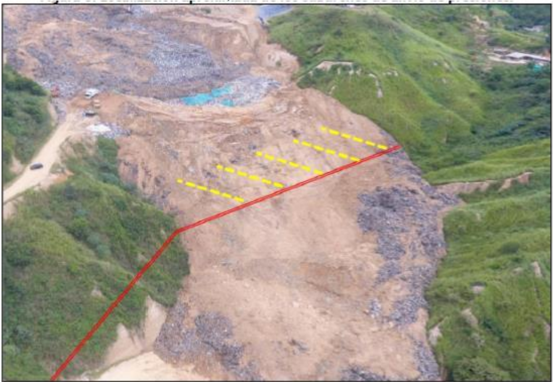
Imagen 43. Localización y sección sugerida subrenes de lixiviados perforados en el dique de la Celda 4 Fase 2.
