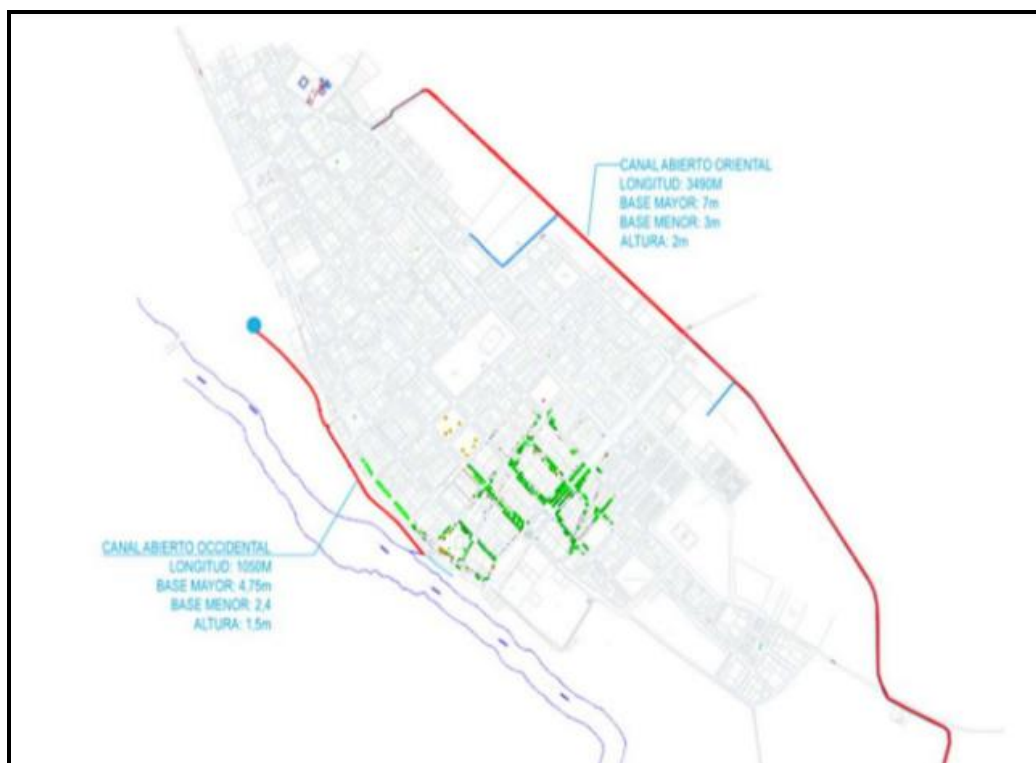
Imagen 9. Redes de alcantarillado Maní
