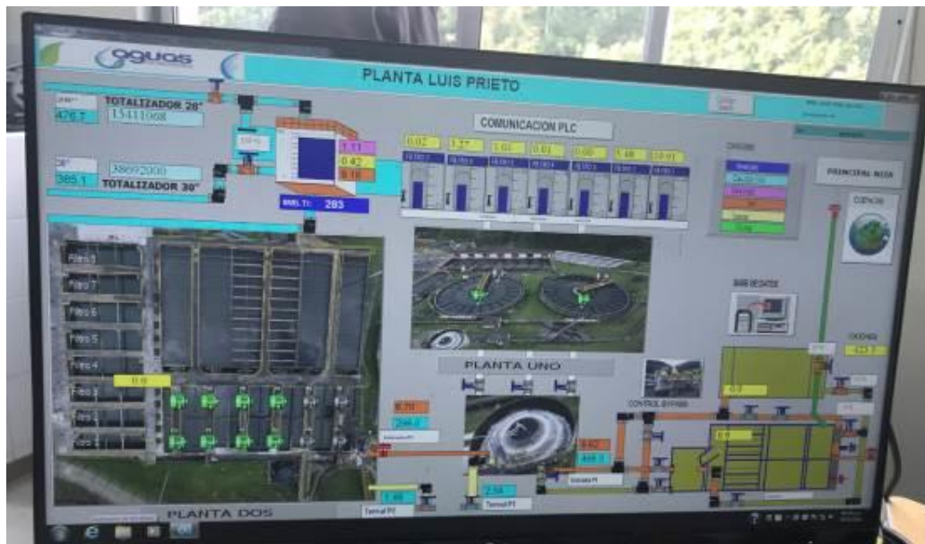
Imagen 10 Interfaz del usuario para la visualización y control de la PTAP
