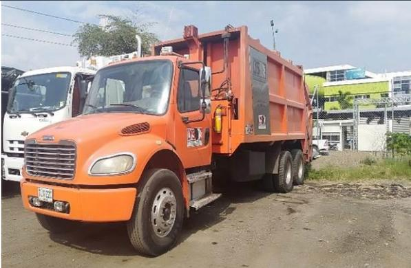
Una fotografía de un camión compactador de color naranja brillante, estacionado en un área de tierra o asfalto. El camión tiene una cabina blanca y una caja de compactación naranja. En el fondo se pueden ver otros vehículos y edificios. |
