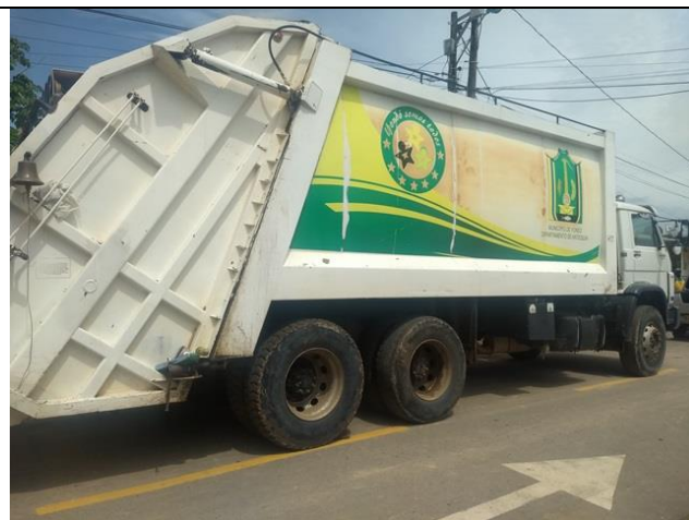
Imagen 83. Vehículo recolector tipo compactador placa OSK 348
