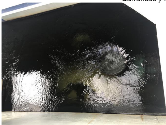
a) Vertedero Morning Glory – Suministro de agua hacia el municipio de Barrancas
