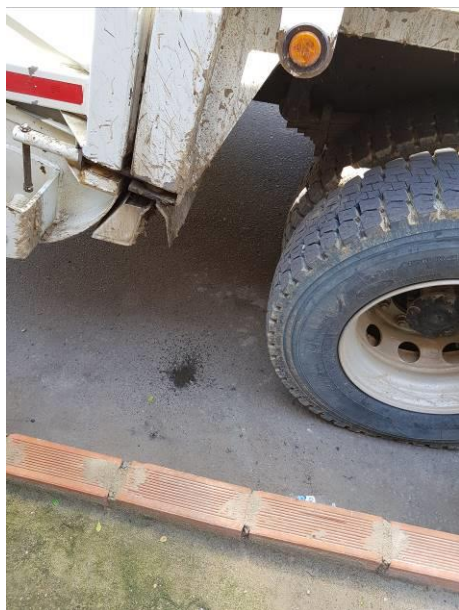
Ilustración 31. Pérdida de líquido (lixiviado) en vehículo de placas TJP 896.
