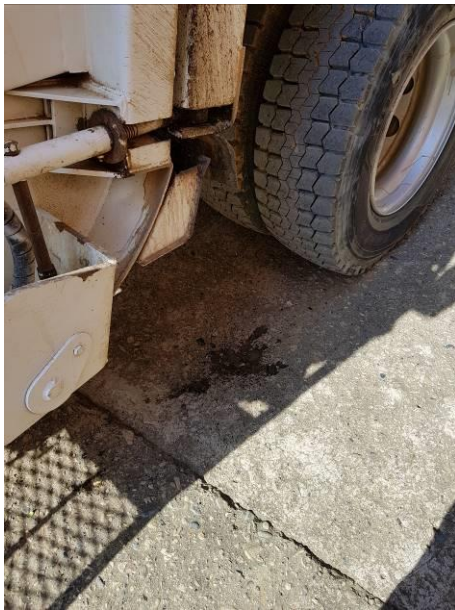
Ilustración 39. Pérdida de líquido (lixiviado) en vehículo de placas TJP 894
