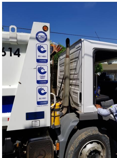
Ilustración 32. Tubo de escape por debajo de la altura máxima del vehículo de placas TJP 896.
