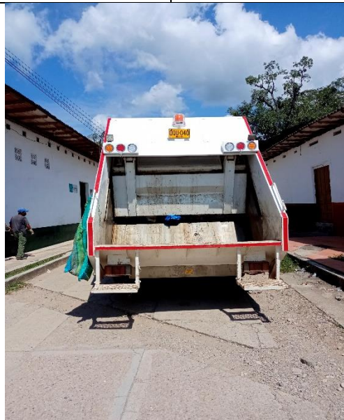
Imagen 15 Verificación 21/02/2022. 2:14 p.m. Baliza, luces de la tolva, estribos y manijas.
