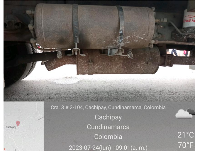
Imagen 28. Tubo de escape por debajo de la carrocería del compactador
