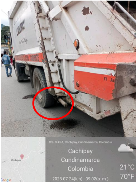
Imagen 27. Derrame de líquidos de la caja de almacenamiento de líquidos
