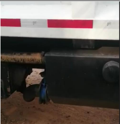
Imagen 47 Caja de lixiviados
