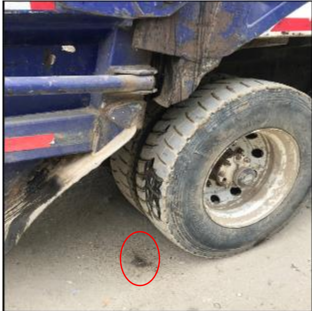
Pérdida de líquido (lixiviado)
