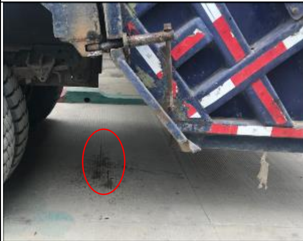
Pérdida de líquido (lixiviado)
