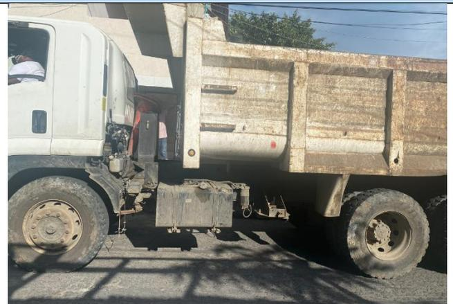
Estribos sin superficie antideslizante, luz estroboscópica sobre caja de compactación
