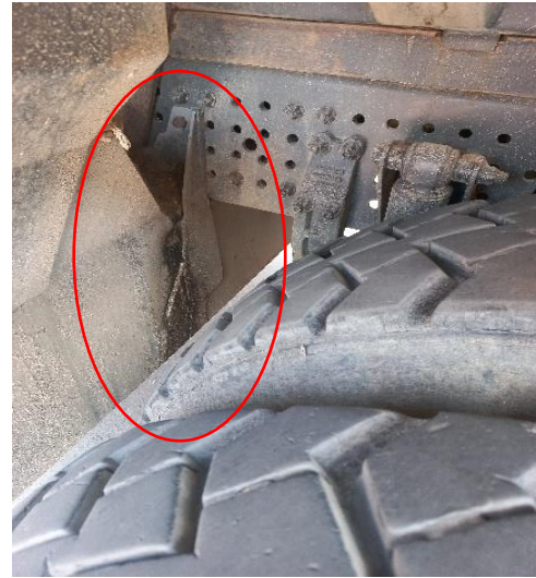
Imagen 48 Pérdida de lixiviado
