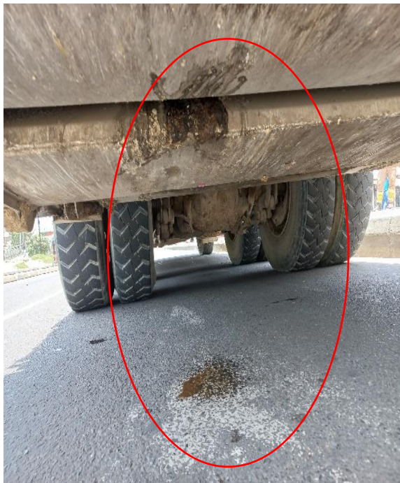
Imagen 39 Pérdida de lixiviado
