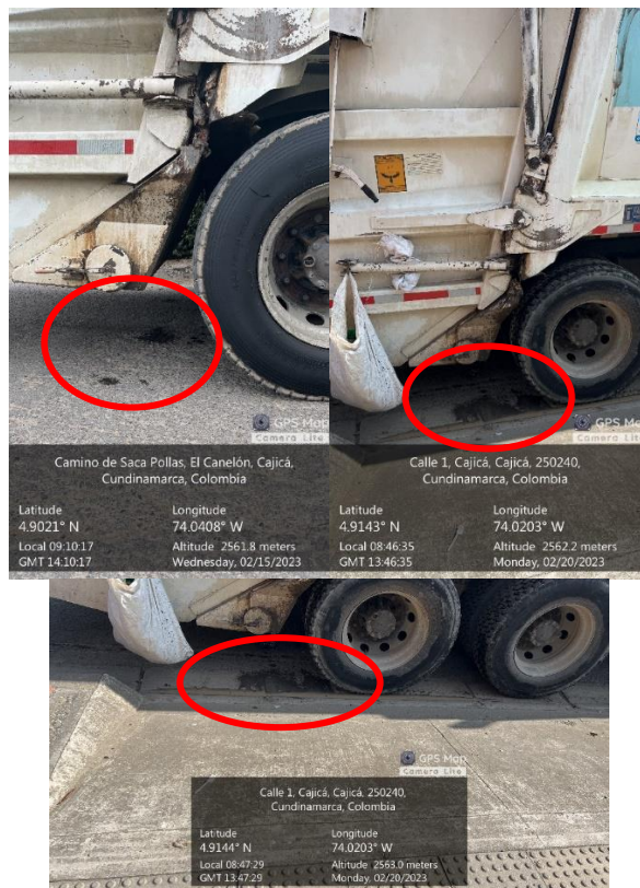
Fuente: Visita SSPD – EPC, febrero 2023 Imagen 31. Fuga de lixiviado en compactador OJG781
