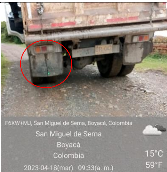
Imagen 34 Fuga de lixiviados parte inferior trasera del volc
