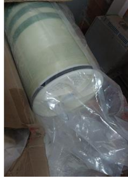
Repuesto membranas de osmosis
