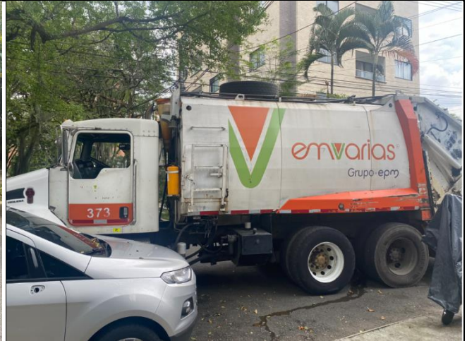
Pérdida de lixiviado en inspección
