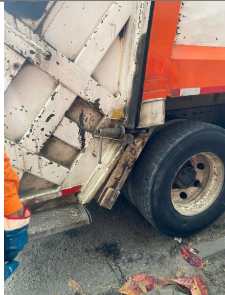
Pérdida de lixiviado
