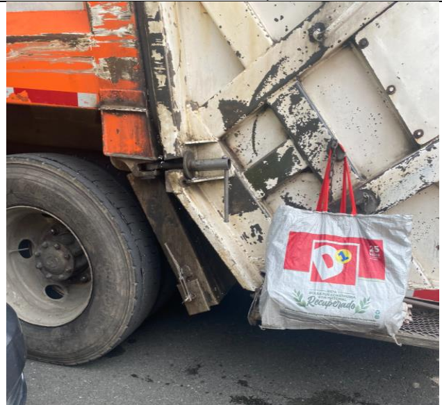
Estribo izquierdo con obstrucción
