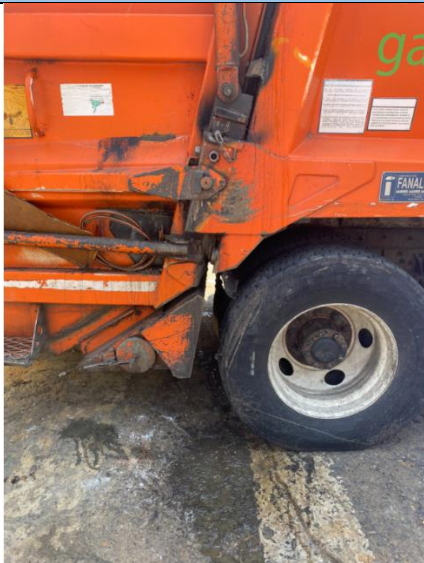
Pérdida de lixiviado
