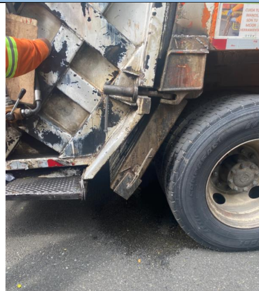
Pérdida de líxiviado
