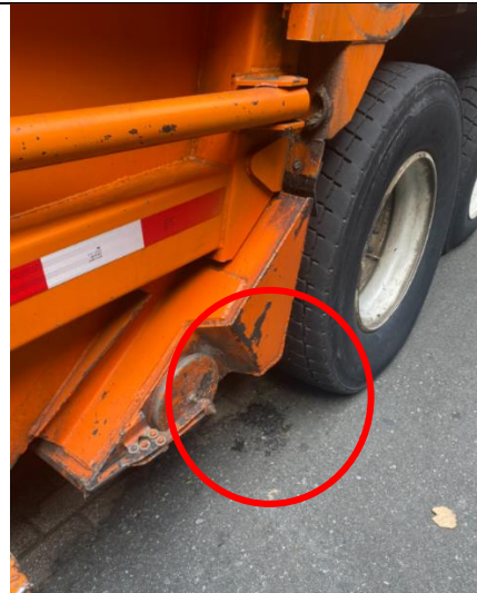
Pérdida de líquido (lixiviado)
