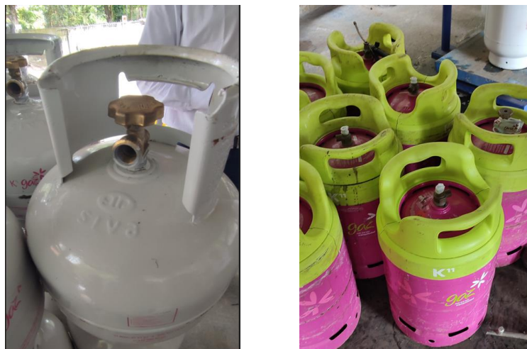
Figura 8. Fotografías de los cilindros evidenciados en la planta de envasado de CLC S.A.E.S.P. – Villeta, Cundinamarca.
