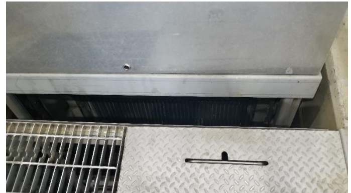
Estructuras de cribado con espaciamentos de 2 cm (Detalle)
