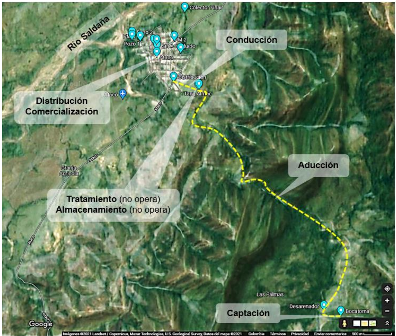
Imagen 9 Esquematación general del sistema de acueducto urbano del municipio de Ataco, Tolima.
