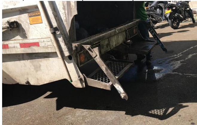
c) Vista trasera, perdida de líquido lixiviado
